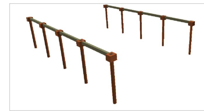
VISTA 3D - FUNDAÇÃO (Z=+0,02) - QUADRA SEM ESCALA
