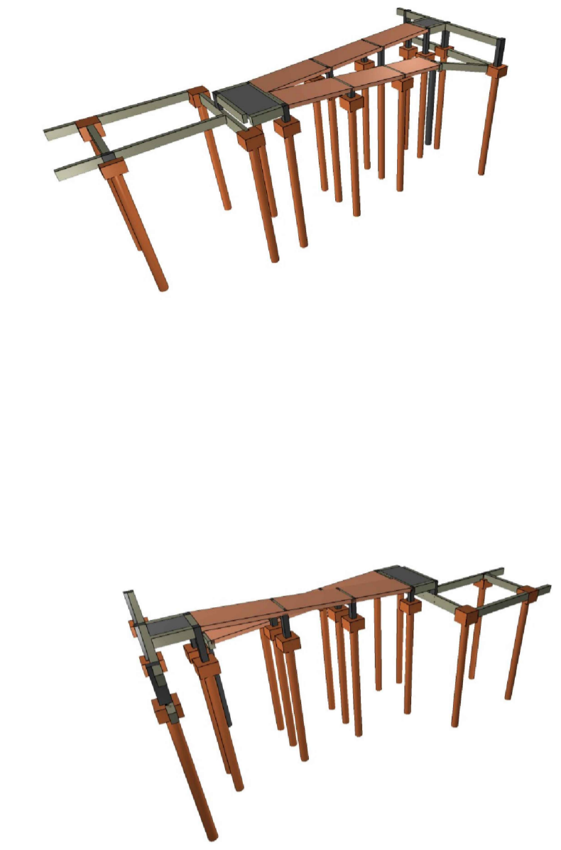
VISTAS 3D - TOPO RAMP (Z=+1,03) SEM ESCALA
