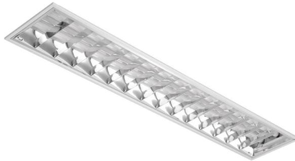
Nos locais indicados pelo projeto deverão ser fornecido e instalado luminária de embutir com 2 lâmpadas led t8 de 10w. Luminária para lâmpadas T8, indicada para uso em ambientes onde há necessidade de controle de ofuscamento rigoroso, como agências bancárias, escritórios e salas de estudo. Ref.: caa02-e216 lumicenter ou equivalente
