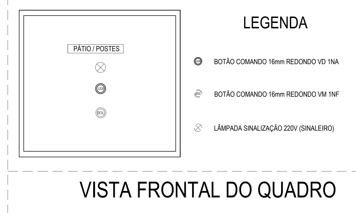
DETALHE 07 - COMANDO POSTES EXTERNOS escala s/e
