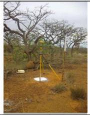
Datum: SIRGAS 2000 Elipsóide: GRS80 Equipamentos utilizados: Trimble 5700 L1/L2 e Topcon Hiper L1
