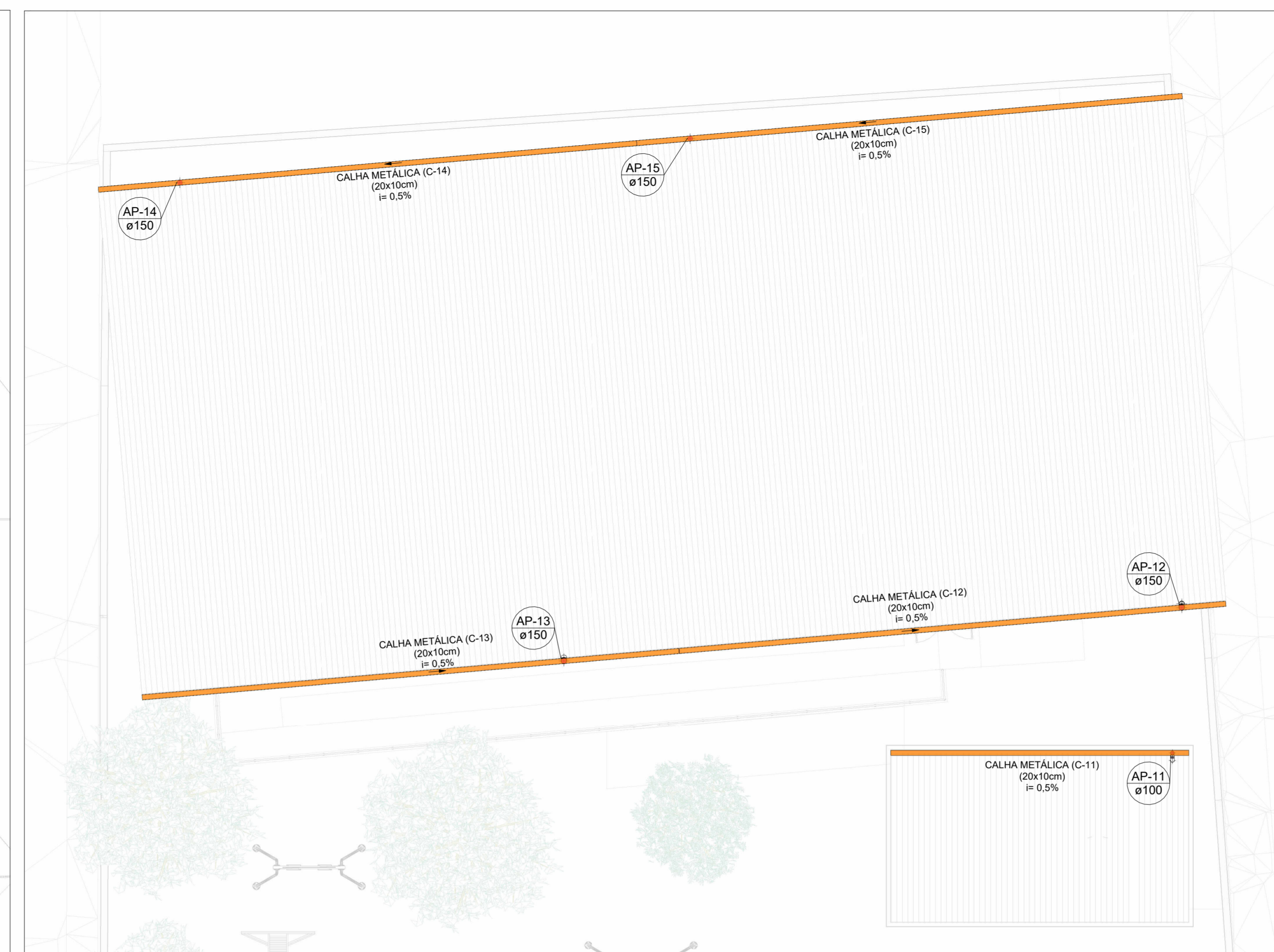
PLANTA BAIXA DRENAGEM PLUVIAL - COBERTURA (PARTE 2) Escala 1 : 100
