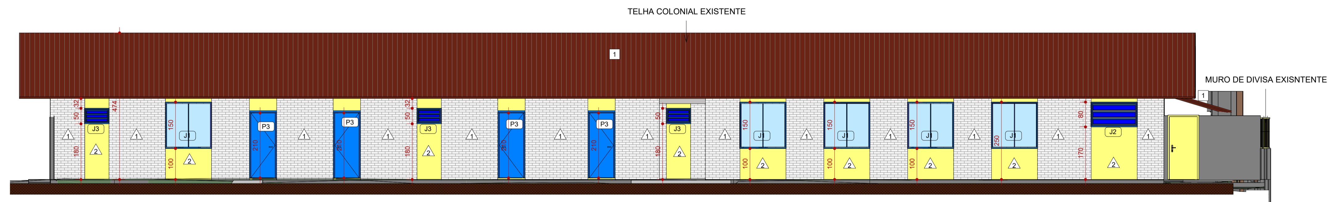
3 FACHADA LATERAL ESQUERDA ESCALA 1:75
